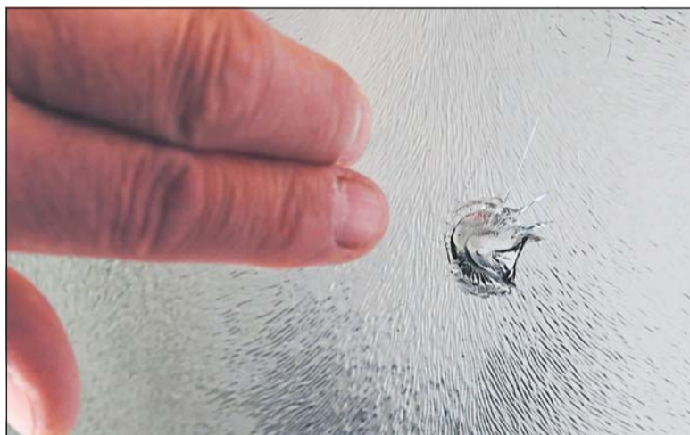
Spuren des Beschusses: Die Kugel hat die Scheibe erheblich beschädigt, konnte die Doppelverglasung aber nicht durchdringen.
